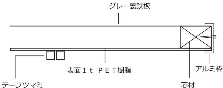
印刷されている表面の板に、型を使用しテープの出る穴を開けています。
