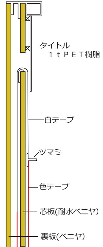
目盛の印刷されている押出成型されたレールを、テープのピッチにあわせて下地の板に貼っていきます。これがテープの上下する溝になります。テープにはつまみを接着しており、溝の中をスライドし裏側で固定されております。
